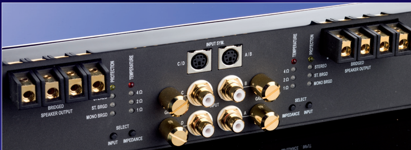
Schlichte Eleganz: Am Gehäuse der Matrix X4 finden sich keine Potis für analoge Weichen oder ähnliche Klangregler. Stattdessen gibt es kanalgetrennte Pegelregler und symmetrische Signaleingänge, die alternativ zu den einzeln verschraubten Cinchbuchsen darunter verwendet werden können. Die LEDs zeigen die Stellung des Eingangswahlschalters und der Impedanz-Umschaltung an.
